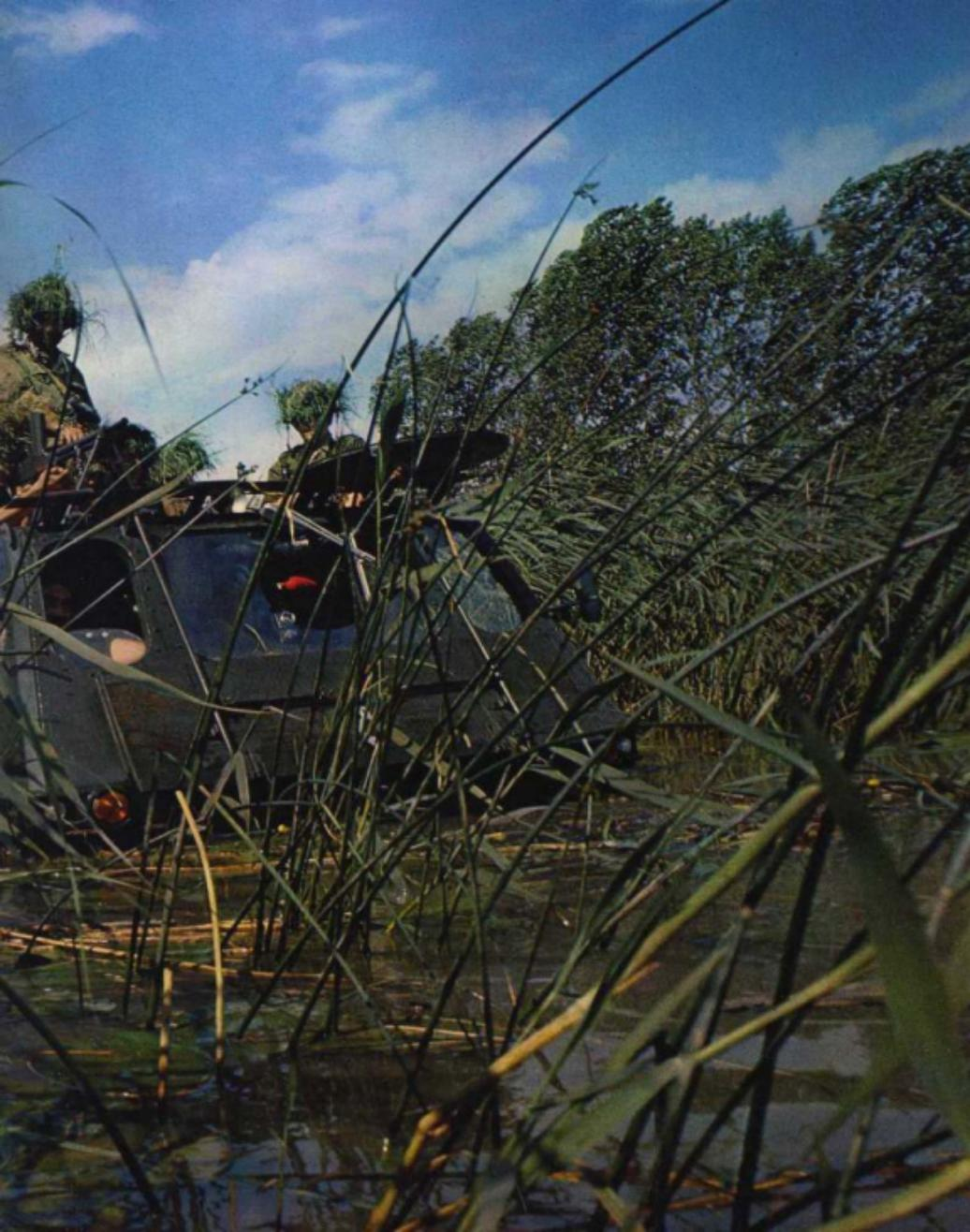
l'**AUROCHS** tous terrains et amphibie peut débarquer 5 tonnes par mer agitée, aborder et gravir les berges les plus escarpées et rayonner encore sur 600 km à 70 km/h sans se ravitailler.
