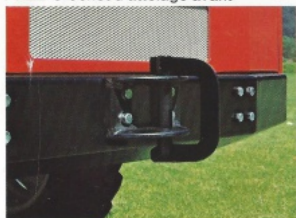
T1035 Crochet d'attelage arrière
