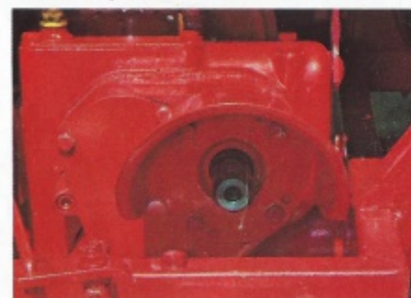
Raccord de prise de force normalisée
