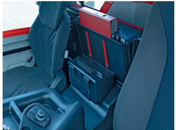
Praktische Ordnerhalterung, Werkzeugbox und hinter der Abdeckung integrierte Batterie und Bordelektrik
