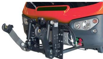
Hydraulisches Fronthubwerk (Option) für VT450 Vario
