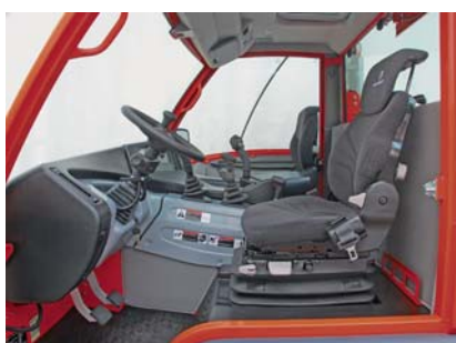
Luftgefederter Komfortsitz (Option) für VT450 Vario, TP420 und TP48/48P
