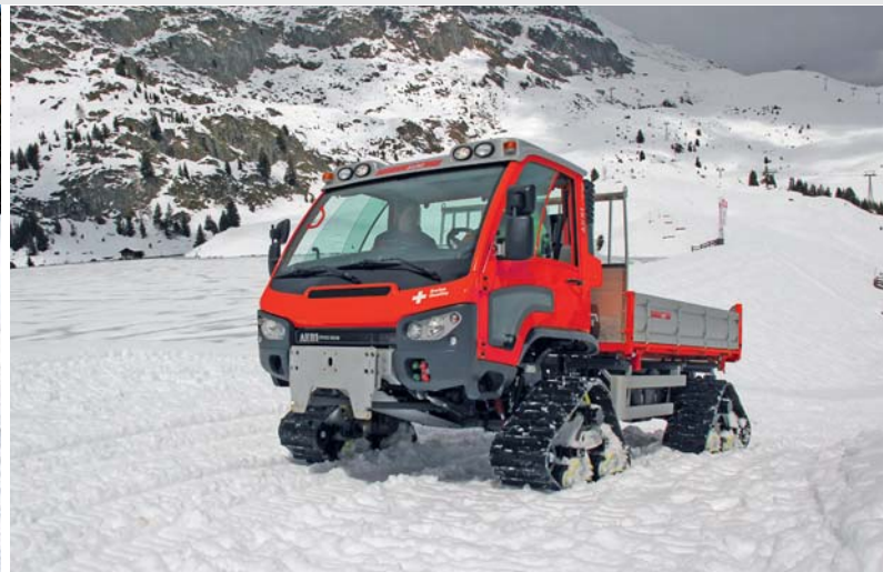
Aebi VT450 Vario Kippbrücke und Raupenfahrwerke
