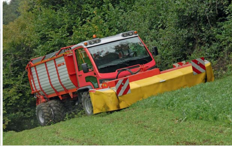
Aebi VT450 Vario Scheibenmäher und Ladegerät
